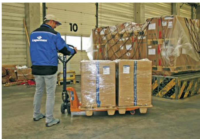
Umreifert oder, wie hier, vollständig mit Folie umwickelt, gilt eine Luftfrachtsendung auf einer Inka-Palette als sicher
