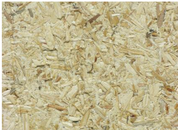
Die Einwegpalette wird aus Holzspänen in Form gepresst. Holzschädlinge können sich nicht einnisten
